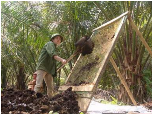
Tấm sàng đất, phân làm bằng lưới mắt cáo 2 lớp, dùng để sàng thủ công
